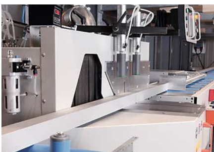
45° und 135° Gehrungsschnitt / 45° and 135° mitre cut
