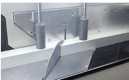
45° und 135° Gehrungsschnitt / 45° and 135° mitre cut
